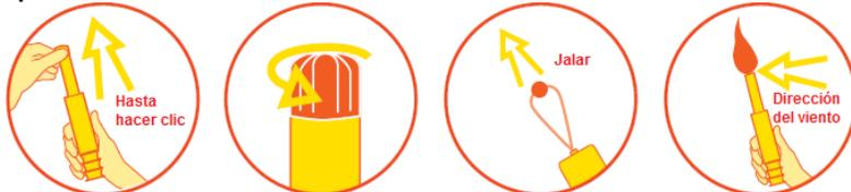
1. Saque el extremo rojo hasta que el tubo telescópico esté completamente extendido y trabado.
